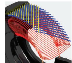
Каркас шины состоит из корда, натянутого от одного до другого борта под прямым углом и без переплетения нитей; мягкая оболочка каркаса по наружной поверхности обтянута мощным гибким брекером из высокопрочного и нерастяжимого стального корда. Боковина не передает деформацию на протектор, что способствует лучшему пятну контакта.
