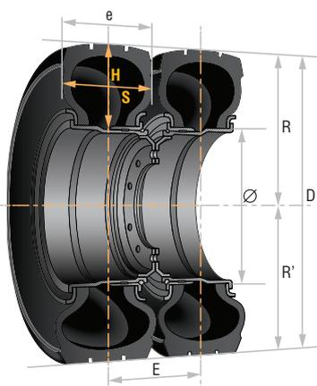
**e:** максимальная ширина профиля шины (смонтированной на обод)
