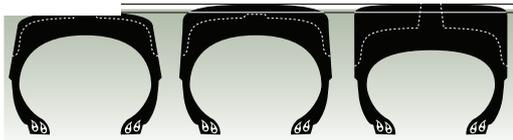
Глубокий и сверхглубокий типы имеют глубину в 1,5 и 2,5 раза больше обычного протектора. Шины с более глубоким рисунком обладают повышенной стойкостью к порезам и износу.
