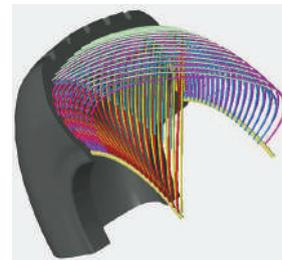
Каркас шины состоит из одной или нескольких пар слоев корда; нити соседних слоев, перекрещиваясь, расположены по диагонали от одного борта к другому под углом меньше чем 90°. Брекерный слой не стабилизирован, при движении шины деформация боковины передается протектору, что приводит к уменьшению пятна контакта.
